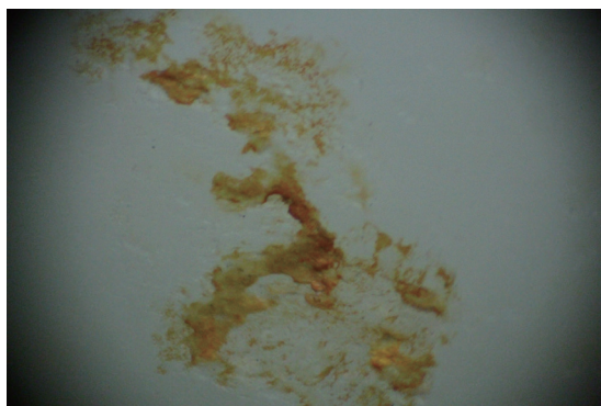
圖11 和田玉仿籽料的染色表面（圖片源自李嘉恆 [6] ） Dyed surface of imitation Hetian jade pebble
